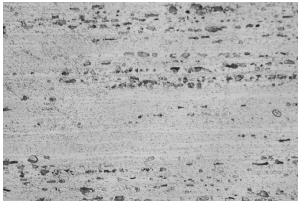
Рис.3.31. Микроструктура образцов из сплава АМг6 при различной степени деформации после прокатки при температуре 520°С и охлаждения между 2-мя слоями плит (x200).
