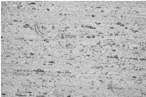
Рис.3.31. Микроструктура образцов из сплава АМг6 при различной степени деформации после прокатки при температуре 520°С и охлаждения между 2-мя слоями плит (x200).
